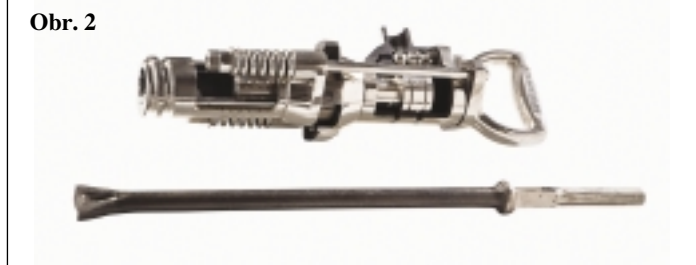
Obr. 2 - Dobový ukázkový pochromovaný řez rychlovrtným vrtacím kladivem Flottmann s kuličkovým rozvodem. Dar firmy Flottmann, cca 1912. Foto Kateřina Uková
