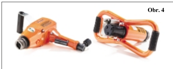
Obr. 4 - Pneumatická vrtáčka vzduchová PV42K Koexpro (vlevo) a hydraulická ruční vrtáčka VHR42/50.1WK Koexpro (vpravo) používané v uhelných dolech či na poloskalní horniny. Dar firmy Koexpro 2013. Foto Kateřina Uková
