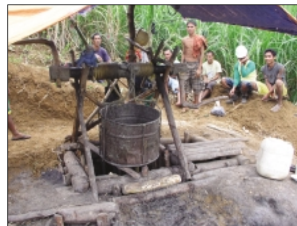
Zajímavé je, že identické řešení klik k rumpálu se našlo stejné v 16. století v Kutné Hoře jako v 21. století na malém uhelném dole na Filipínách. Zahnutá větev posloužila zcela stejným způsobem napříč kulturami, časem i prostorem. Foto: Jan Kučera
