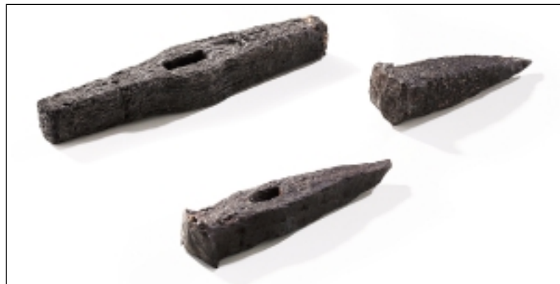
3. Nářadí pro ruční ražbu z 16. – 18. století: mlátek s nauhličenými plochami k tlučení (Jáchymov), želízko (16. – 18. století; Jilové-Kabáty), skalní klín (Lubietová, SR). Sbírký NTM, foto Kateřina Uksová.
