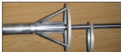
Detail měřicího systému kavernoměru HC 380 s nasazeným kalibračním kroužkem
