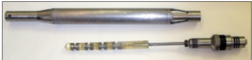
Detail měřicího systému kavernoměru HC 380 s nasazeným kalibračním kroužkem
