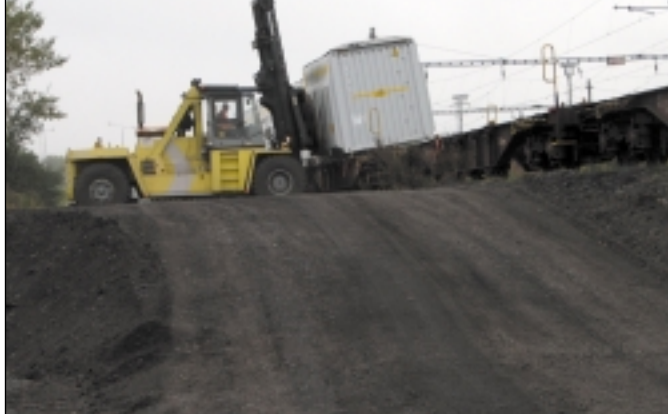
Usazování kontejneru s palivem GEOBAL 4, uzavřeného víkem tzv. Hard-Topem na železniční soupravu na koleji č. 527 v Ostravě
