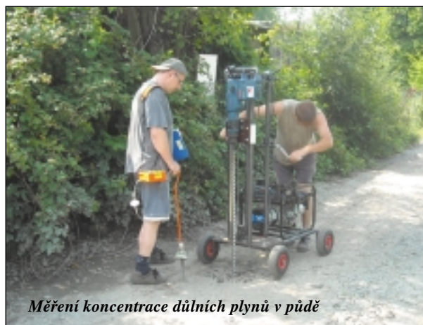
Zařízení pro měření dynamiky výstupu důlních plynů
