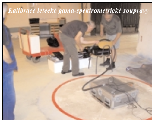
Kalibrace gama sondy v uranovém modelu
