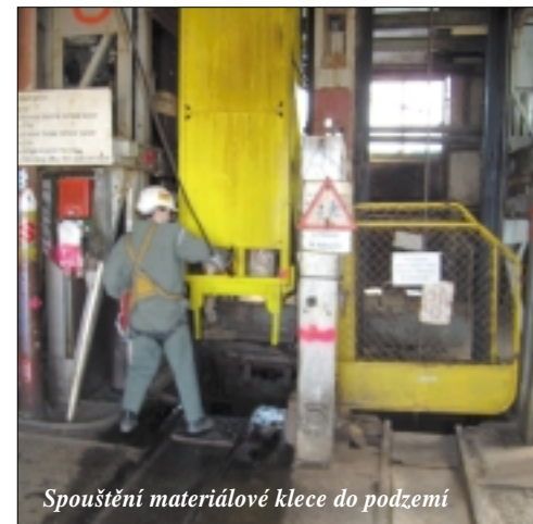
V závesné materiálové kleci je klancíček s dolovinou
