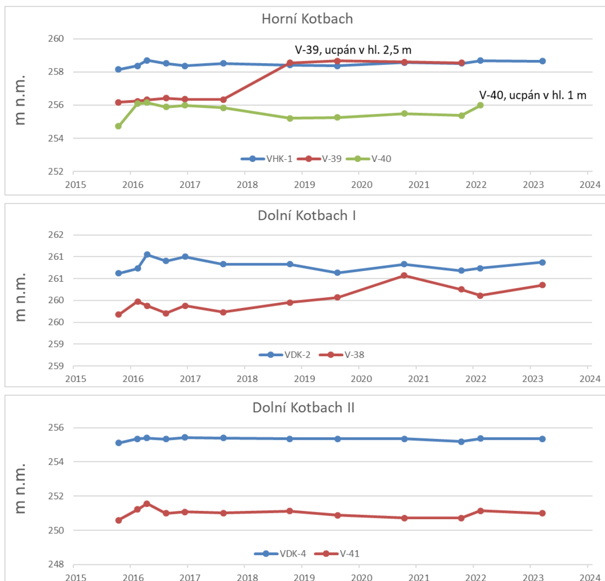
Obrázek 3 Dlouhodobý vývoj hladin vodních nádrží a průsakových vod
