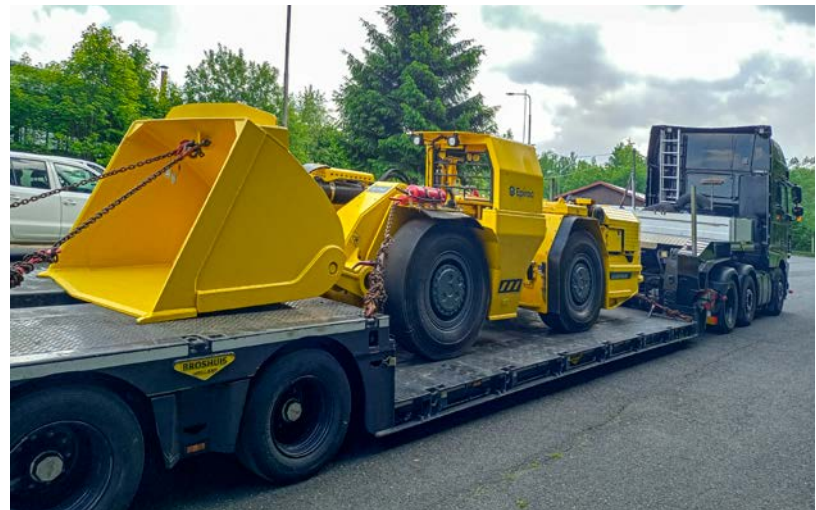
Dopravení důlního kolového kloubového nakladače do areálu
