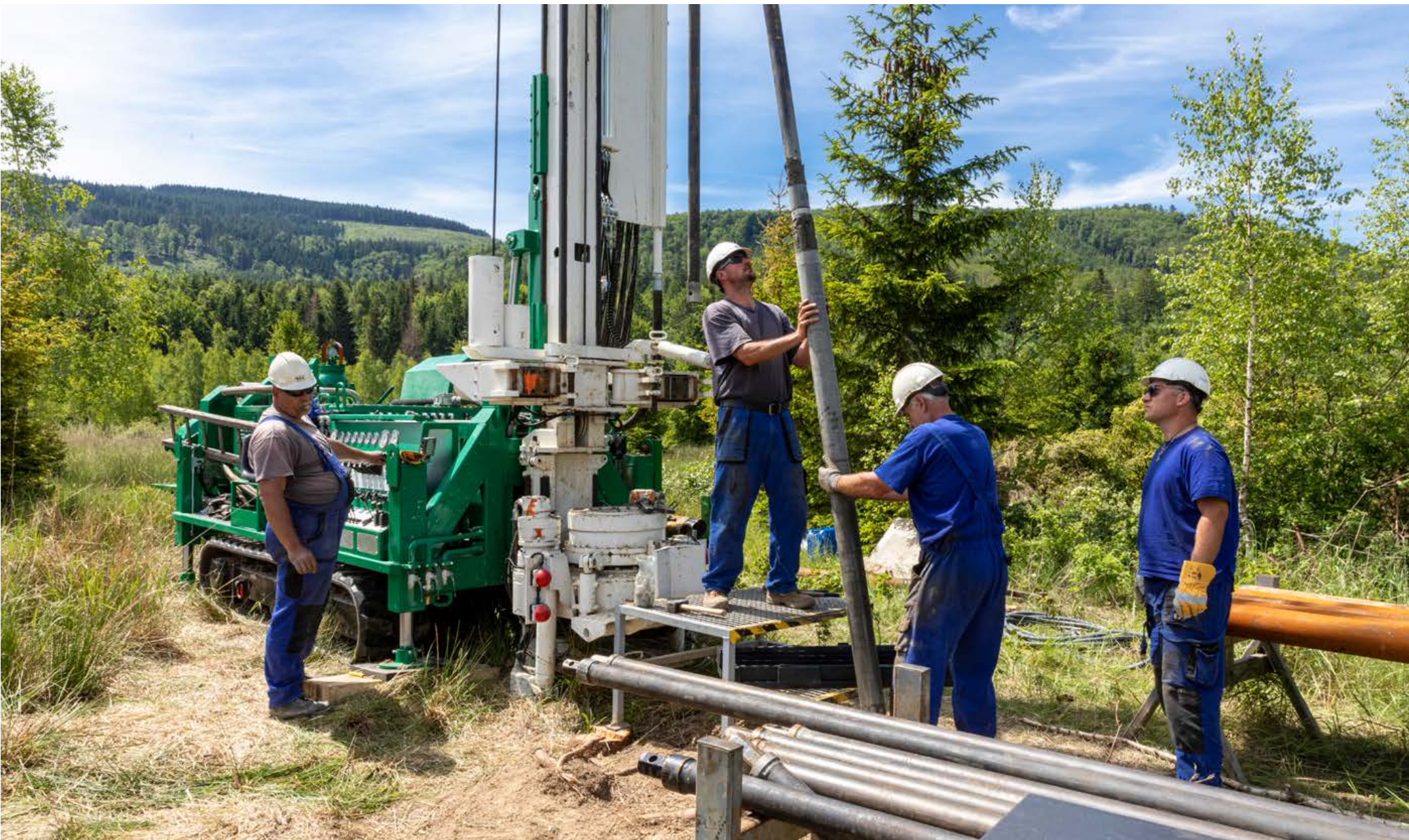
Obsluha vrtné soupravy po vytěžení vrtných tyčí s jádrovkou z vrtu po odběru vzorku kalů
