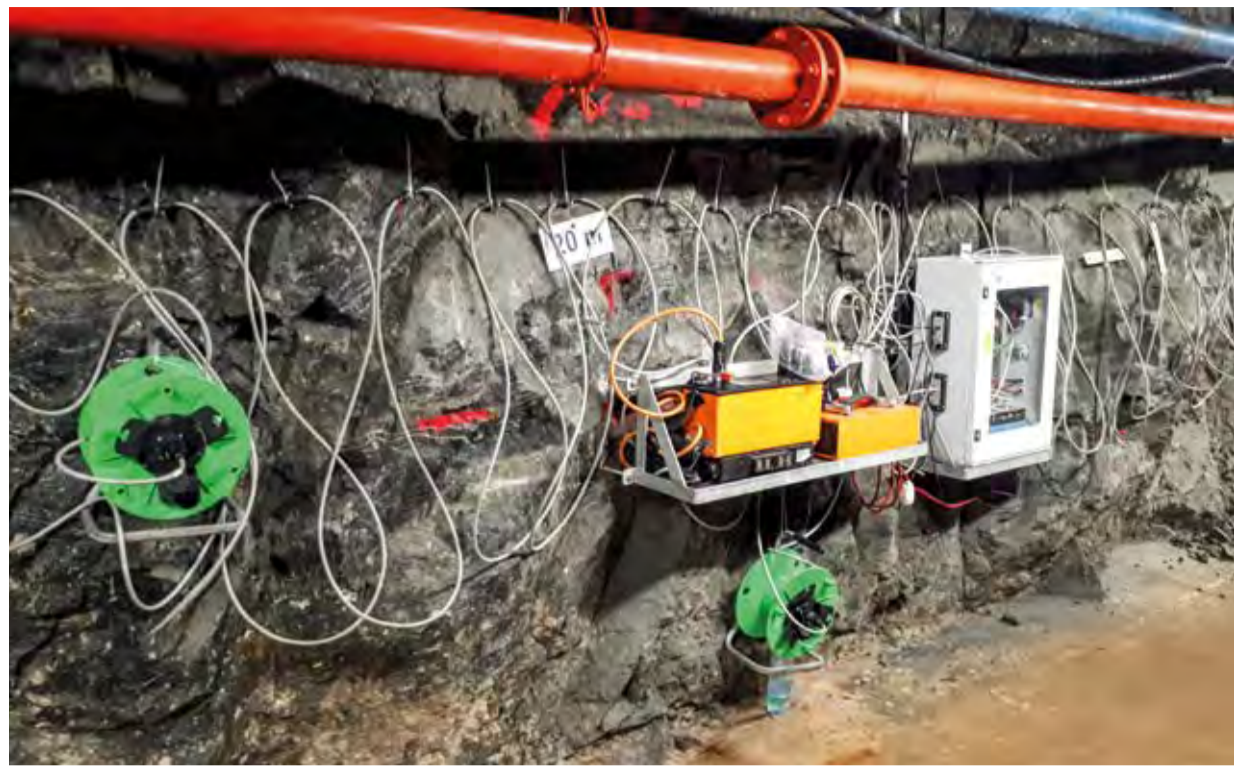
Dlouhodobý monitoring horninového masivu nedestruktivními geofyzikálními metodami na laboratorním překopu BZ, -XII
