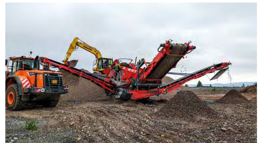
Mobilní třídička TEREX Finlay 883+ na odvalu šachty č. 19
