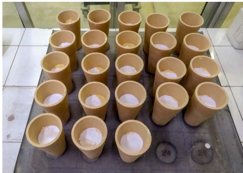
Připravená směs rudy a chemikálií na tavení
