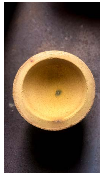
Zrno drahých kovů po odstranění olova
