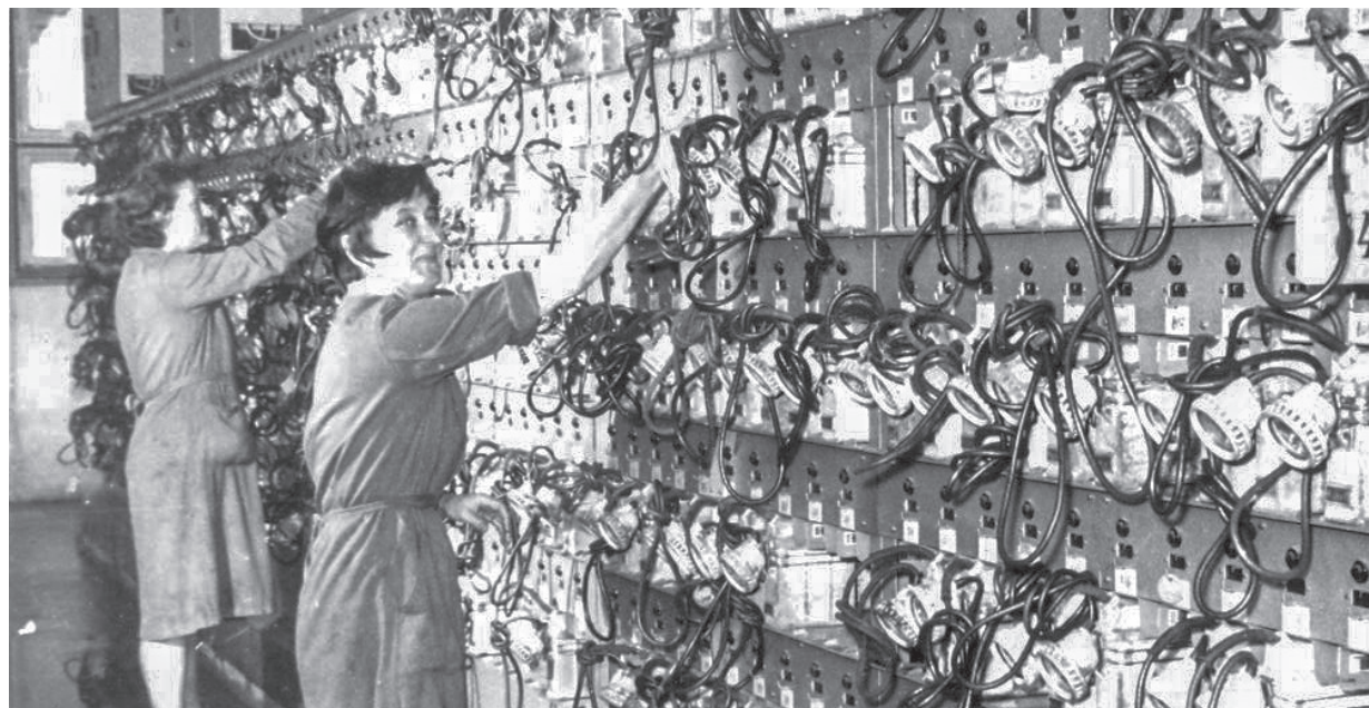
Šachta č. 16, lampovna, samoobslužná nabíjecí stanice důlních lamp
