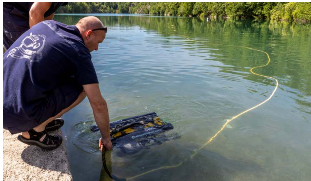
Potápěčský robot se výrazně podílí na úspěších báňských záchranářů – potápěčů.
