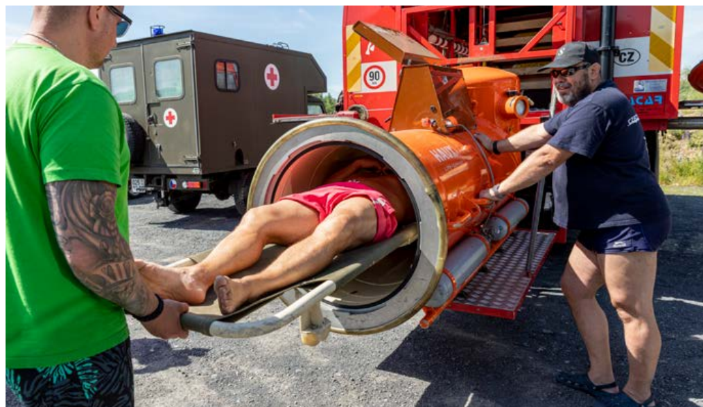
Na akci musí být přítomen i lékař. MUDr. David Skoumal popisuje funkci dekompresní komory s názornou ukázkou postupu při záchraně potápěče postiženého tzv. kesonovou nemocí.
