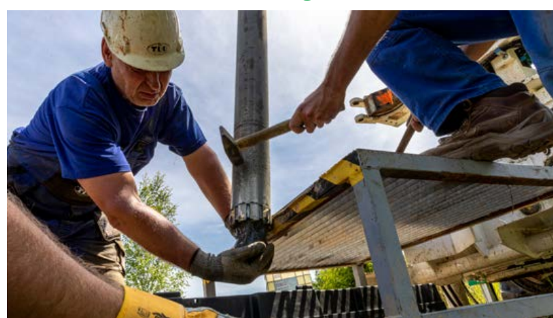
Pracovníci vrtného úseku o. z. TÚU vytlačují vrtné jádro z jádrovky
