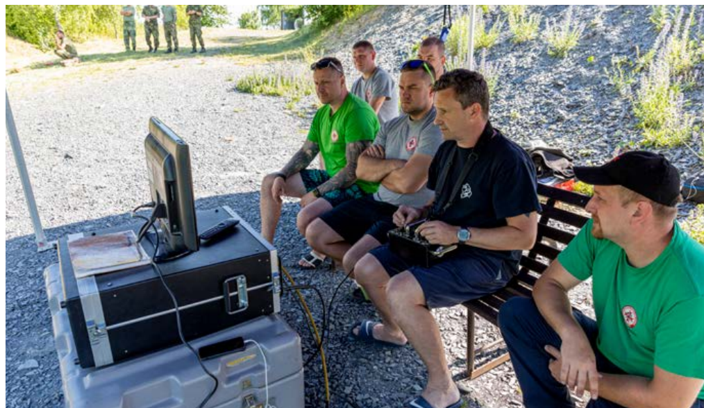
Tým obsluhy potápěčského robota. Robot je ovládán pomocí speciálního ovládacího panelu z povrchové základny, kam přenáší obraz z prostředí pod vodou. Operační hloubka je max. 150 m.
