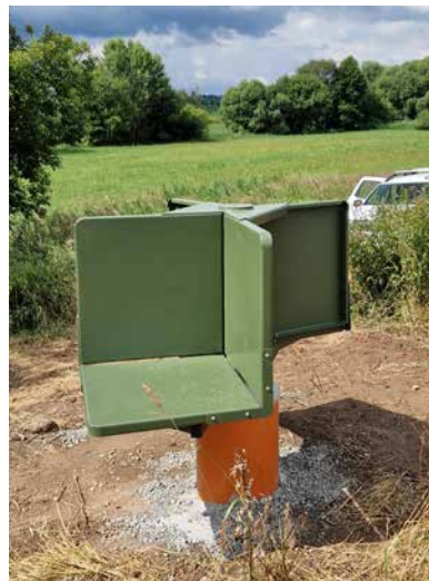
Ukázka instalace koutového odražeče v terénu – Tu-5
