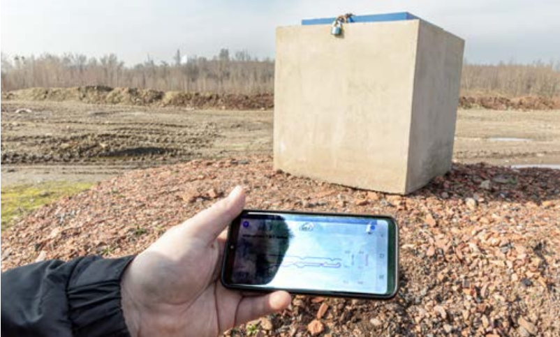
Kontinuální termický monitoring v OVS s přenosem do aplikace mobilního telefonu, únor 2024
